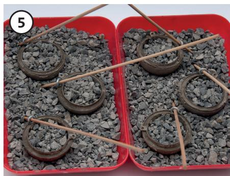
5 Lasciare solidificare il calcestruzzo per circa 10 minuti. Per ogni guscio di cemento, inserire un golfare nello strato di cemento tra le due metà della sfera. Inserire la vite ad anello il più verticalmente possibile in modo che il guscio di cemento possa successivamente appoggiarsi comodamente contro il palo. Fissare la vite ad anello con gli spiedini di bambù per evitare di affondare nel cemento. Lasciare asciugare i gusci di cemento per almeno 1 giorno (durante la notte).
