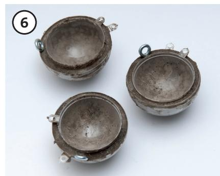
6 Rimuovere il guscio interno dopo l'asciugatura. Per facilitare il rilascio, il guscio può essere leggermente riscaldato con un asciugacapelli.
